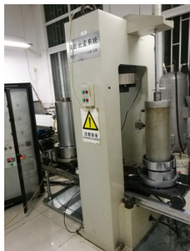
图 2 RLW-2000 M 微机控制煤岩流变仪
